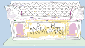
FIG. 4 GRAFICAZIONE DEGLI ELEMENTI DI DEGRADO DEL SARCOFAGO DI ANNIA FAUSTINA, INSERITO NELLA CORRISPONDENTE SCHEDA CONSERVATIVA.
