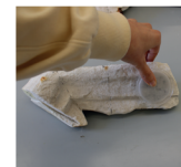
Esecuzione delle analisi di assorbimento di acqua tramite spugna di cotone
