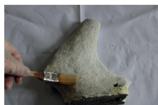
Sperimentazione di diverse modalità di applicazione dei consolidanti
