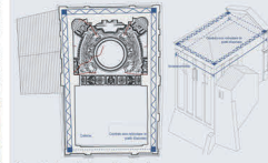
Proposta di cerchiatura ed incatenatura
