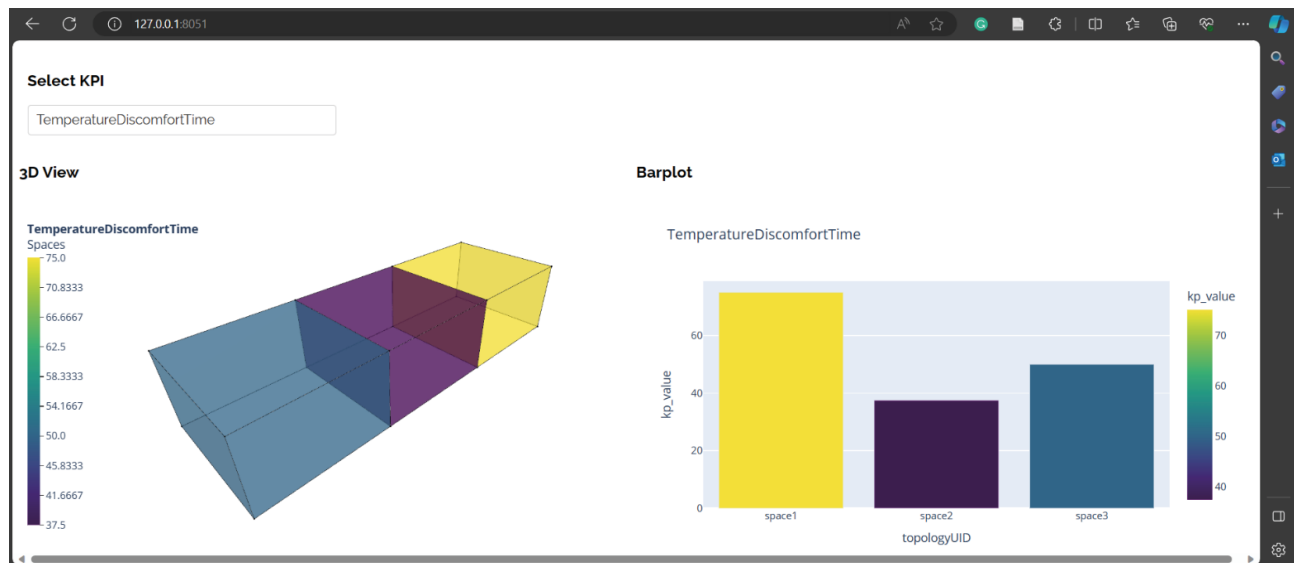
Fig. 5. Dashboard interattiva per la visualizzazione dei KPI per l'analisi prestazionale del caso studio presentato.
